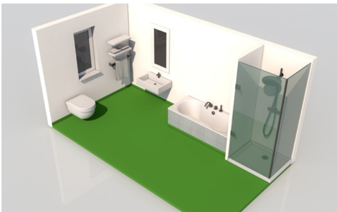
Abb. 5: Häusliches Bad mit Badewanne und Duschtasse mit Du- schabtrennung (grün = CAF, CTF)
